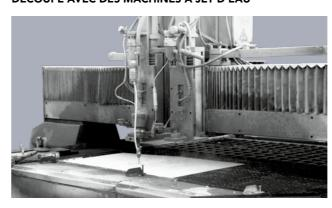
Le grès cérame laminé peut être découpé à l'aide de machines de découpe au jet d'eau. La vitesse d'avancement de cette opération doit être comprise entre 2 et 3 m/min.
