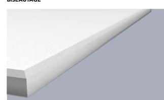
Le grès cérame laminé peut être biseauté. Pour adoucir des arêtes courbes, utilisez une machine CNC avec une meule 5 axes. Différents disques sont disponibles selon la finition des chants souhaitée. La vitesse d'avancement doit être testée au préalable.
