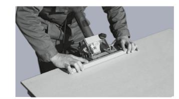
L'utilisation de la meuleuse avec des chariots spécifiques permet l'exécution d'une partie chanfreinée plate avec des angles compris entre  $35~^{\circ}$  et  $55~^{\circ}$  (avec des chariots type Jolly-Angle de Sigma) ou des chanfreins arrondis (avec un chariot type Power-Raizor de Raimondi).
