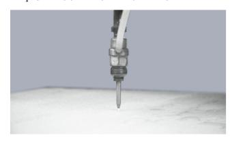
Le grès cérame laminé peut être percé avec des machines de découpe au jet d'eau. Avec les machines à jet d'eau, on peut obtenir des trous de plus petit jourmètre, par rapport aux machines CNC. La vitesse d'avancement doit être comprise entre 2 et 3 m/min.
