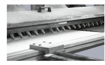
Pour obtenir des coupes à 45 °, utilisez des disques jourmant appropriés pour cet angle. Ainsi, il est possible de joindre deux dalles de grès cérame laminé pour créer un coin. Le coin obtenu doit alors être biseauté. Différents disques sont disponibles selon la finition des chants souhaitée. La vitesse d'avancement doit être testée au préalable.
