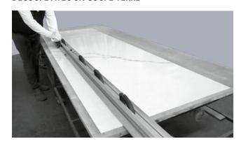
Le système de découpe de carrelage grand format est un outil très utile (par exemple KERA-CUT de Sigma ou Raizor de Raimondi). Pour le grès cérame laminé 3plus, 5plus et 6plus, faire l'entaille sur la partie céramique, séparer la dalle et terminer l'opération en coupant le treillis en fibre de verre à l'aide d'un cutter standard.
