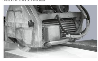
Le grès cérame laminé peut être coupé avec des disques jourmant. Utilisez des disques spécialement conçus pour le grès cérame et en bon état de fonctionnement.
