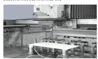
Le grès cérame laminé peut être découpé à l'aide de machines CNC. La vitesse de rotation de la fraise est comprise entre 12 000 et 18 000 tr/min et la vitesse d'avancement entre 0,5 et 1 m/min.
